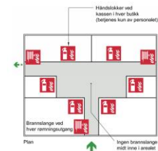
Fig. 841 Eksempel på type slukkeutstyr og plassering i kjøpesenter
