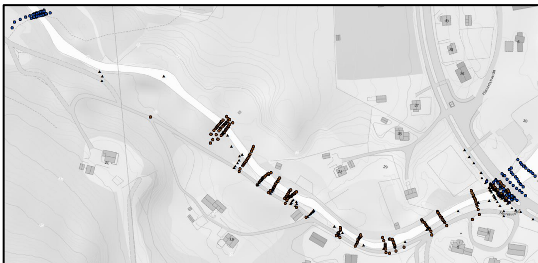
Figur 5. Oversikt over innmålinger i Storelva; RTK-GPS-innmålinger utført september 2016 (svarte trekkanter), RTK-GPS-innmålinger utført juni 2018 (blå prikker) og målepunkter utført med totalstasjon juni 2018 (røde prikker).
