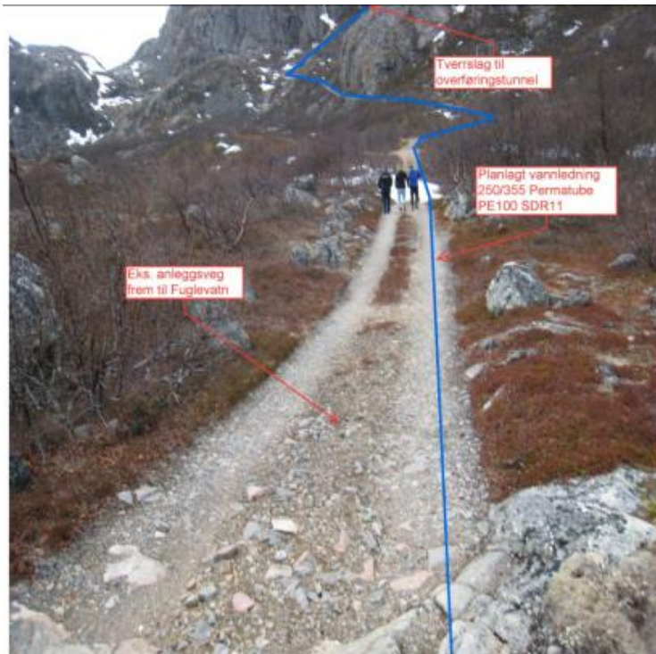
Figur 5-2 Trase for planlagt vannledning fra vanntunnel
